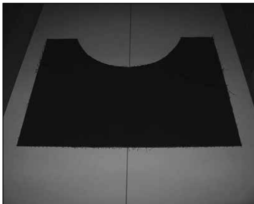
（写真.12）遮蔽用の鉛ゴム板
